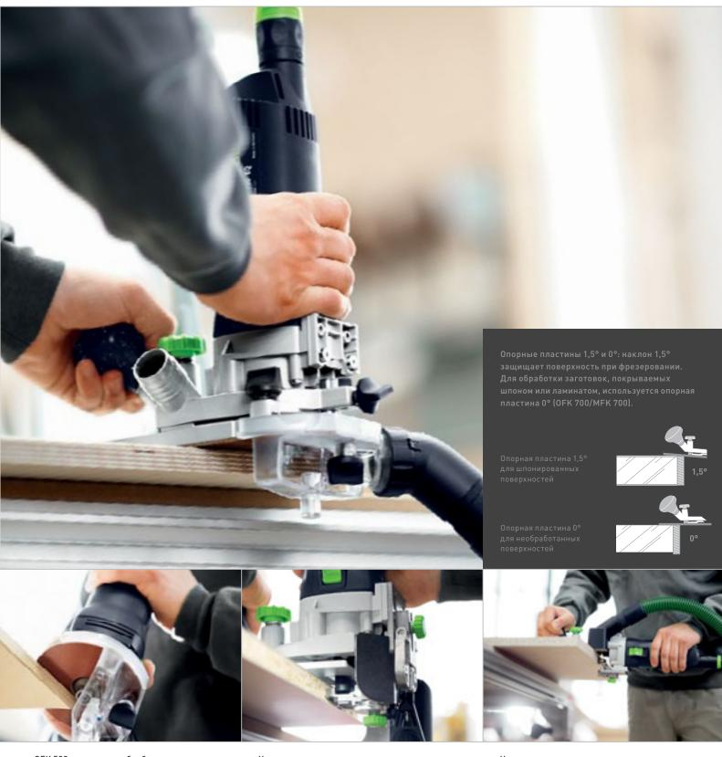
ОFK 500 производит обработку при очень незначительном удалении фрезы от опорной пластины. Результат: исключается брак, фрезер не соскальзывает на углах и вы получаете в целом более высокое качество обработки.
