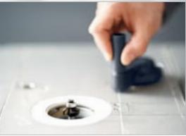
Удобная регулировка рабочей высоты фрезы при помощи съёмной рукоятки, которую можно установить под столом и над ним.
