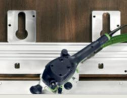
Для выборки пазов и отверстий под обычную соединительную фурнитуру с нижней стороны столешницы служат оба шаблона для выемки замочных скважин на APS.
