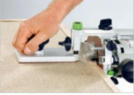
Быстро и надежно – комплект для обработки кромки, для фрезерования заподлицо деревянной кромки толщиной до 28 мм.
