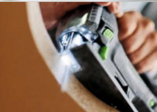
Выполнение пропилов точно по линии разметки – подсветка создаёт видимость неподвижности пилки, отвод пыли и функция обдува CARVEX позволяют всегда видеть разметку.
