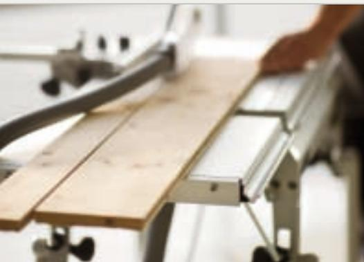
Простое расширение – удлинитель стола позволяет распиливать вдоль большие заготовки.
