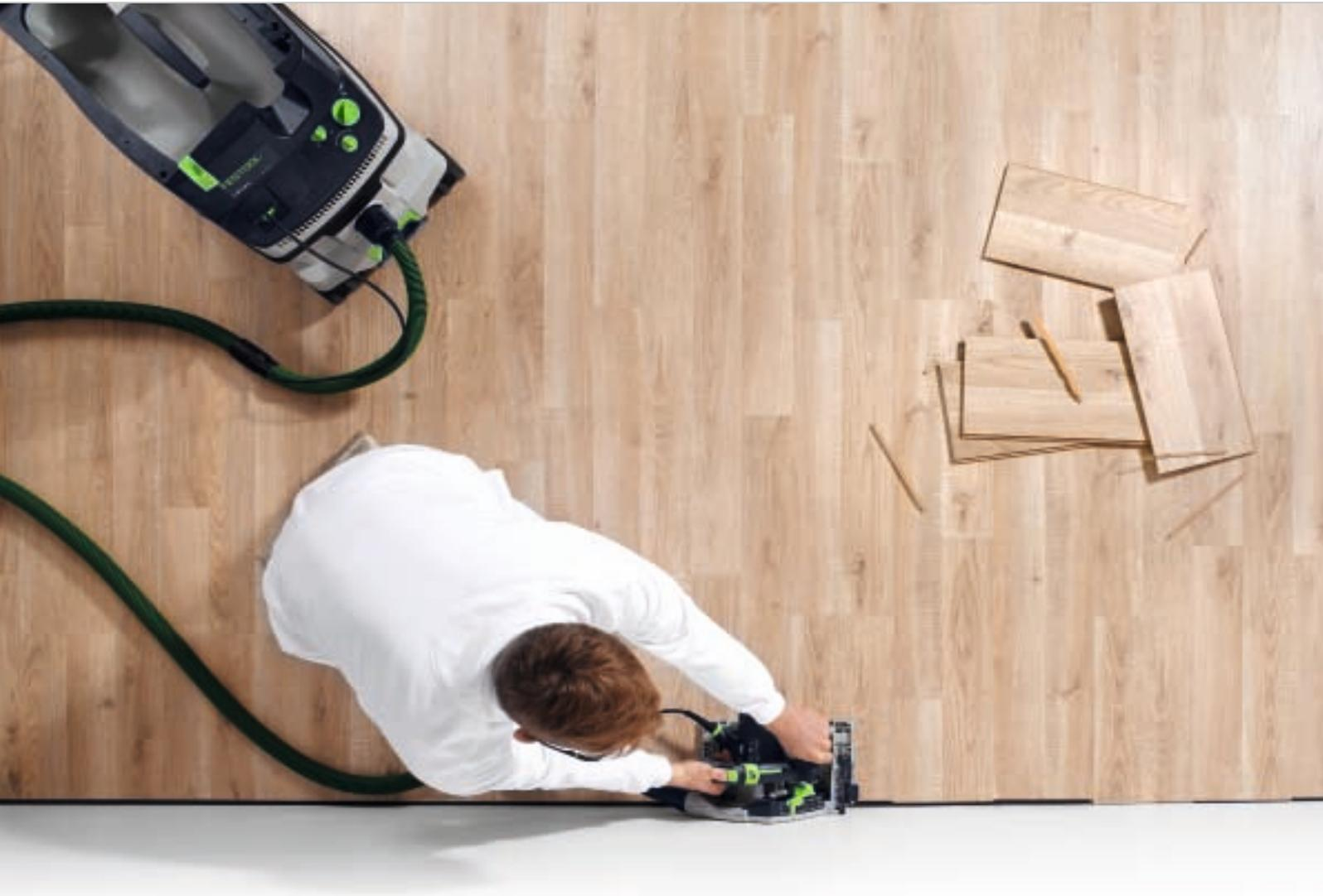
Максимальная гибкость – ультраплоский дизайн корпуса TS 55 R позволяет пилить вдоль края на удалении от стены всего 12 мм.
