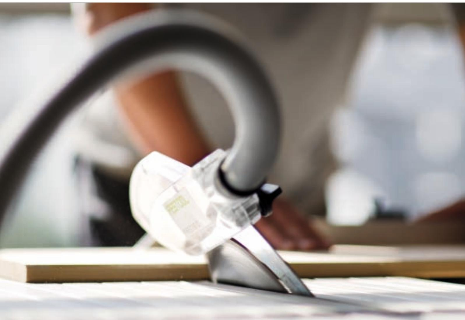
Гарантированная точность – поворотный пильный диск позволяет выполнять точные пропилы под углом от  $-2^\circ$  до  $47^\circ$  или продольные пропилы глубиной до 52 мм (CS 50) или 70 мм (CS 70).
